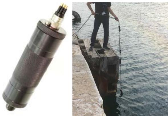
*Figura 8. Sistema hidrofónico inteligente SDHS con capacidad de registro y grabación de medidas acústicas de forma atendida o programada.*
