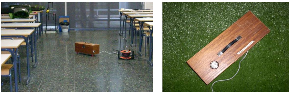
Figura 2- Mediciones sin y con el material. Máquina de impactos normalizada en aula emisora de la EPSG-UPV.
