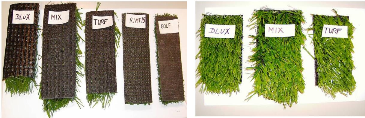
Figura 4-Detalle de las fibras de 3 de las muestras y el reverso de la base porosa de todas las muestras
