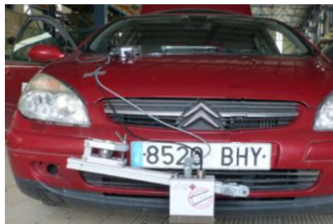
Figura 3.- Detalle del perfilómetro Laser del equipo LaserDynamicPG-LA 2 IC.
