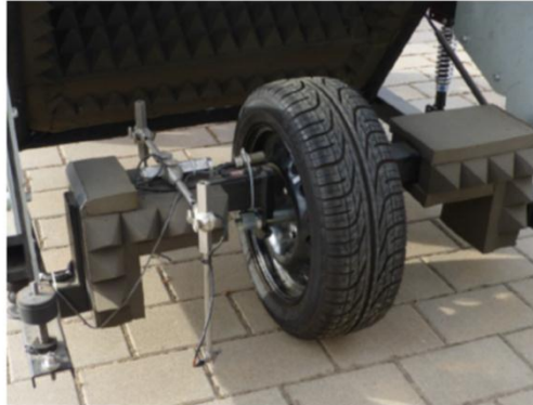
Fig.2.- Equipo Tiresonic Mk4-LA 2 IC. Disposición de micrófonos.
