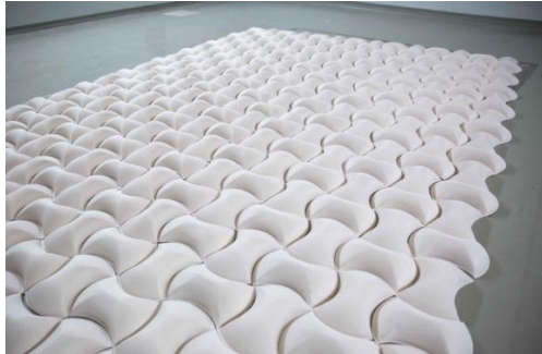
Configuración del ensayo en cámara reverberante
