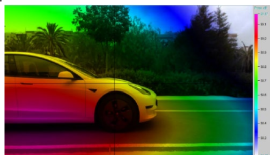
Figura 8. Ensayos Pass-by empleado la cámara acústica
