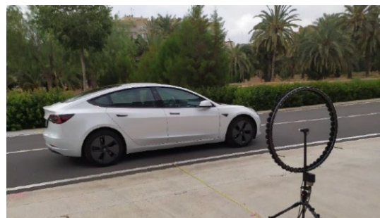
Figura 7. Ensayos Pass-by empleado la cámara acústica
