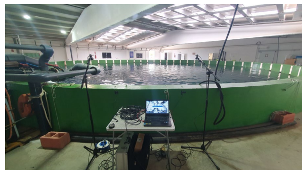
Figura 3. Equipo de medida situado junto al tanque 1 y empleado en la caracterización de ruido y vibraciones.
