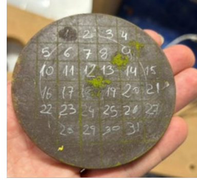
Figura 2. Detalle de una de las muestras de ensayo. Ejemplo de matriz de divisiones en una muestra para evaluación de la dispersión de los ensayos.
