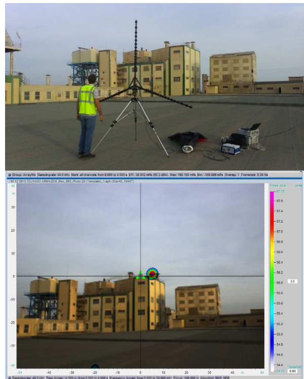
Figura 8. Ilustração dos testes realizados a 100 m das fontes de ruído em estudo.
