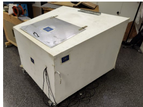
Figura 5. Detalle de ensayo en cámara reverberante a escala.
