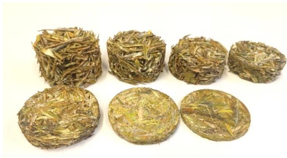
Figura 1. Probetas para la caracterización acústica.
