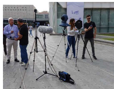
Figura 3. Evaluación objetiva mediante instrumentación, paseos sonoros ISO12913, Elche_2022.
