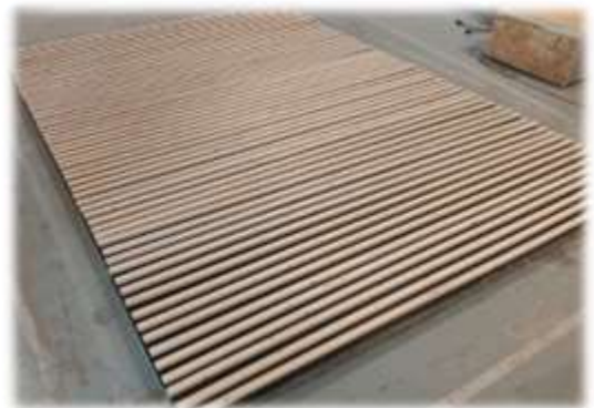
Figura 9. Muestra de lana mineral con listones de madera
