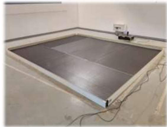
Figura 3. Muestra para ensayo de absorción acústica.
