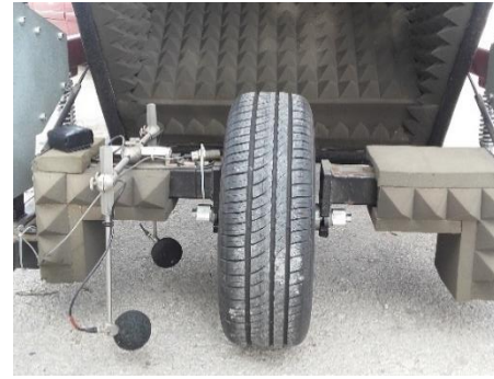
Figura 1. Cámara semianecoica del Tiresonic Mk4-LA 2 IC.
