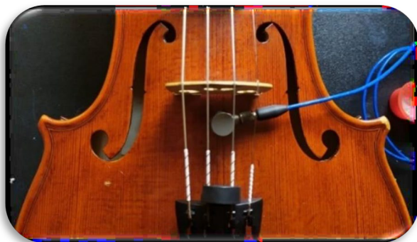
Figura 4. Colocación del acelerómetro en el violín.
