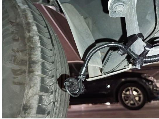
Figura 3. Micrófono exterior instalado en vehículo
