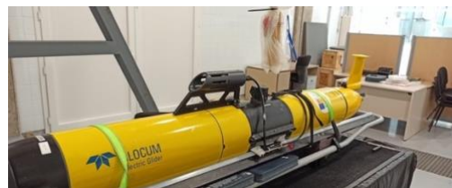
Figura 2. Glider Slocum G2 de Teledyne Webb Research con el sistema PAM OceanObserver de JASCO Applied Science instalado en la sección media donde se ubica el muelle científico. Se puede apreciar en la imagen el hidrófono M36 instalado en la parte dorsal del glider.
