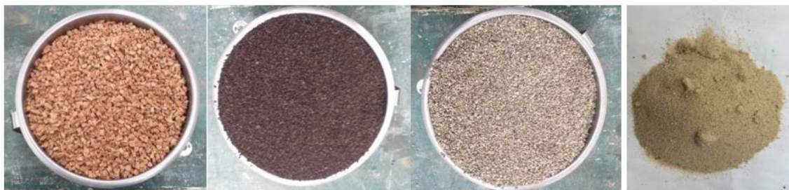
Figura 1 – Materiais usados neste estudo (da esquerda para a direita: cortiça natural (NC), cortiça expandida (EC), argila expandida (AE), e areia (REF)).
