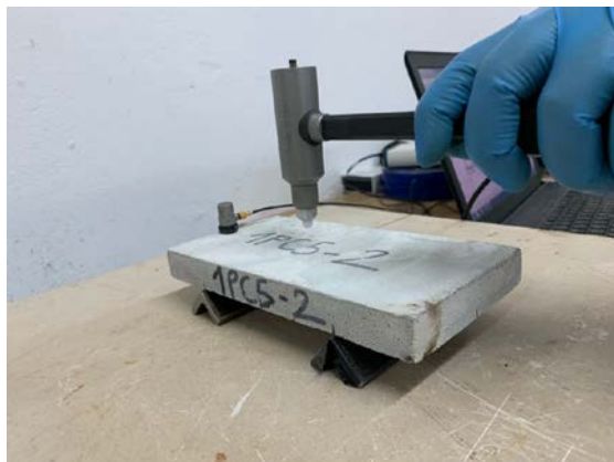
Figura 3 – Exemplo de ensaio para determinação da frequência de ressonância.
