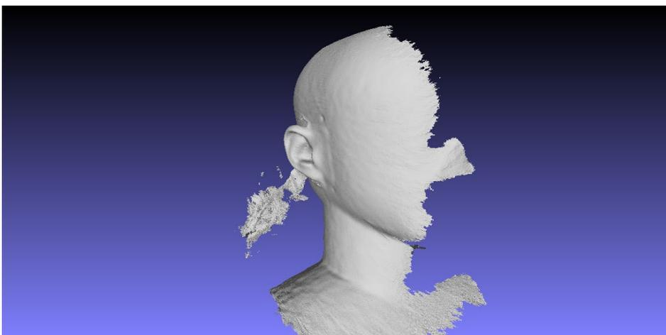
Figura 3 – Escáner del lado derecho del sujeto con una resolución de 0.5 mm.
