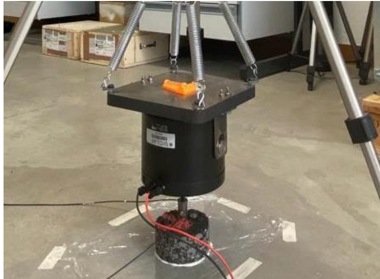
Figura 1.- Equipo de medida utilizado para efectuar los ensayos de rigidez dinámica en laboratorio. Excitador de vibraciones y cabeza de impedancia.
