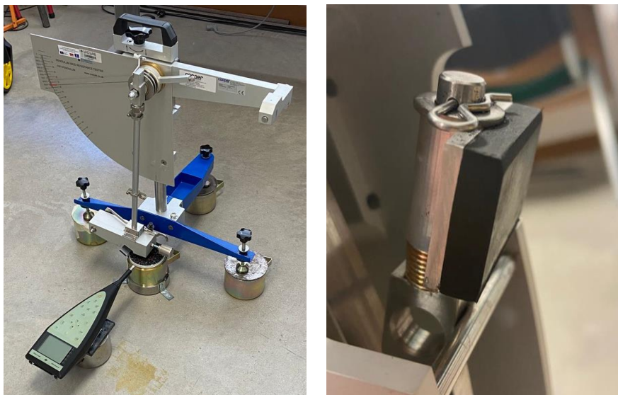
Figura 2.- Equipo de medida de resistencia al deslizamiento de pavimentos. Péndulo de fricción y patín acondicionado según norma.
