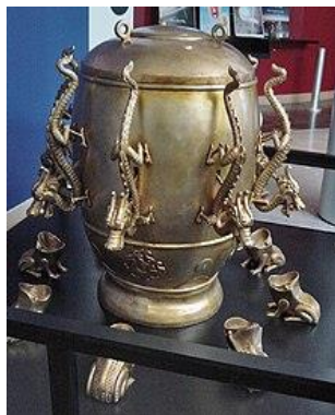
Figura 2 – Sismógrafo de Zhang Heng
