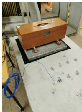
Figura 1: Imagem da instalação laboratorial utilizada para determinar a redução sonora resultante do ruído de percussão a) sem revestimento de piso; b) com o revestimento de piso.
