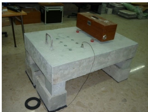
Figura 1: Imagem da instalação laboratorial utilizada para determinar a redução sonora resultante do ruído de percussão a) sem revestimento de piso; b) com o revestimento de piso.
