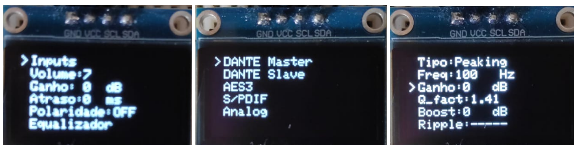
Figura 5 – Visualização dos menus no display OLED. Principal menu (lado esquerdo), Inputs menu (centro) e Tipo de filtro (lado direito)
