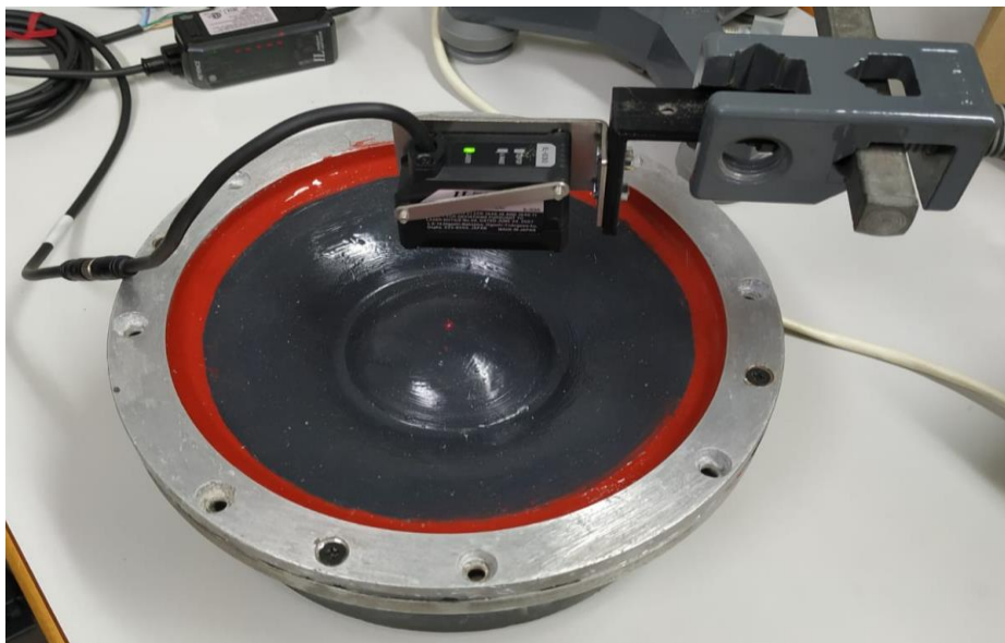
Figura 4. Montaje para la medición del desplazamiento de la membrana.
