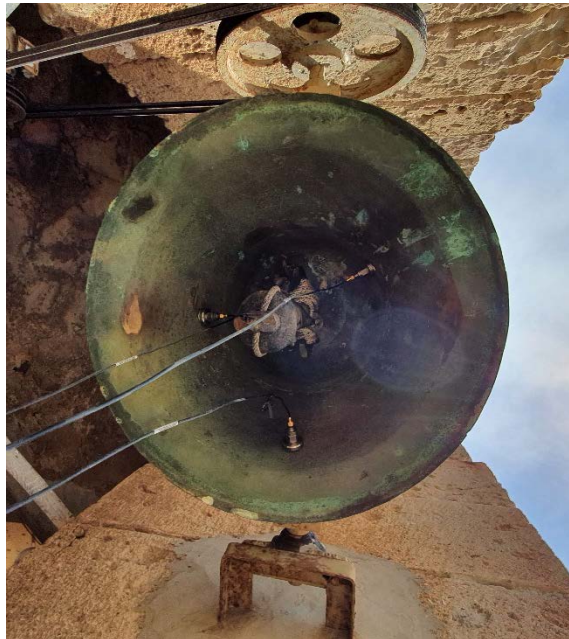
Figura 3 – Situación de los acelerómetros empleados en el análisis modal experimental de las campanas.
