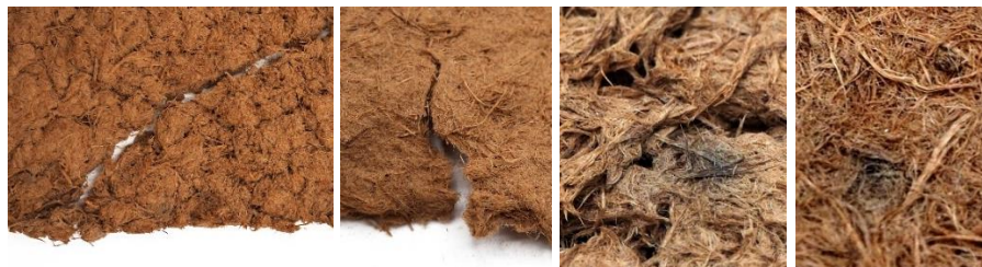
Figura 8 – Rotura en muestras 1 y 2; y moho en muestras 1 y 2.
