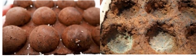
Figura 18 – Porosidad por la cara de atrás y moho en la Muestra 5_Huevera.
