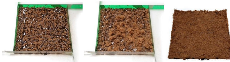
Figura 10 – Aplicación de capa de adhesivo, de fibra y Muestra 3_Sándwich.
