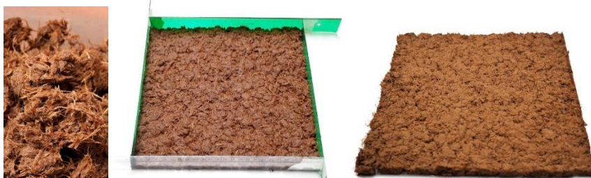
Figura 3 – Mezcla, moldeado y Muestra 1_Panel.
