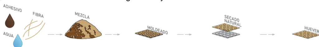
Figura 15 – Diagrama de fabricación de la Muestra 5_Huevera.
