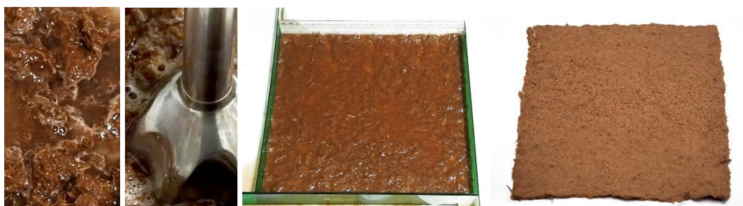
Figura 6 – Mezcla, triturado, moldeado y Muestra 2_Lámina.
