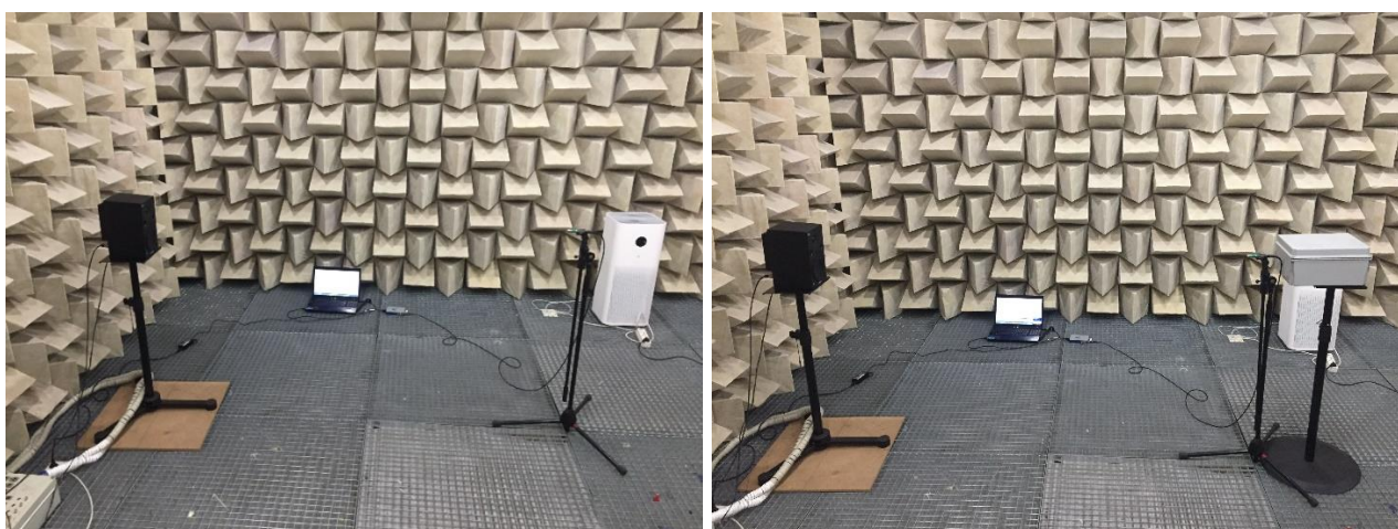
Figura 2.- Izquierda: Medida de referencia para el montaje del modelo del micrófono demasiado próximo al cuerpo del equipo con la primera configuración (sin la presencia de la caja). Derecha: Medida con la presencia de la caja grande a 15 cm del micrófono.
