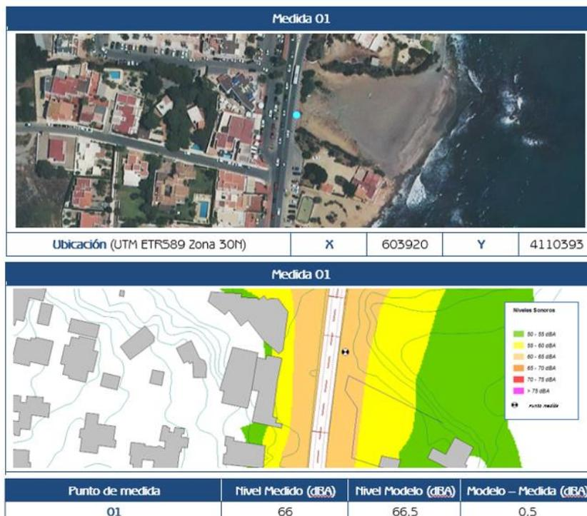
Figura 2 – Ejemplo calibración en un punto de una carretera.
