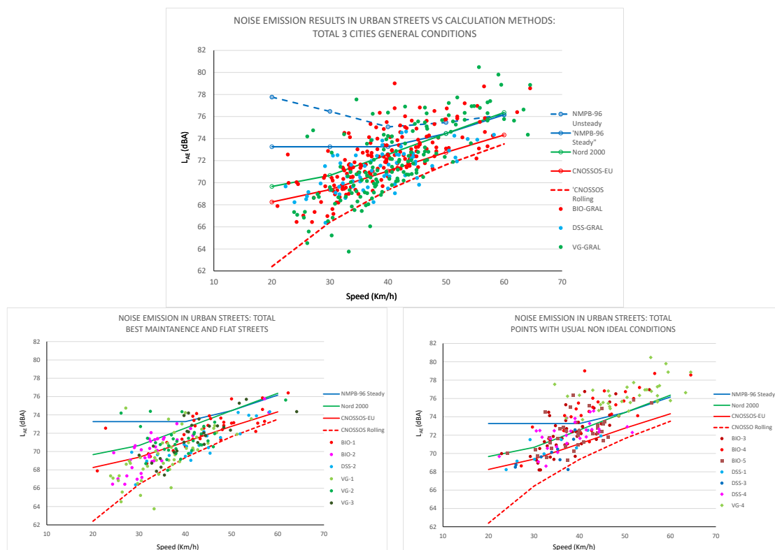
Figura 1 - Resumen de resultados en evaluaciones de emisión de tráfico urbano: efecto de pavimento [1]. Arriba, resultados totales, abajo diferenciación por estado del pavimento.
