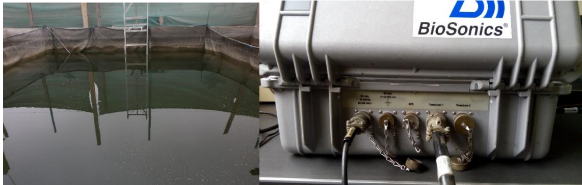
Figura 2. A la izquierda, estanque con el soporte del transductor (en el estanque) y, a la derecha, la ecosonda Biosonics DT-X (Sala).
