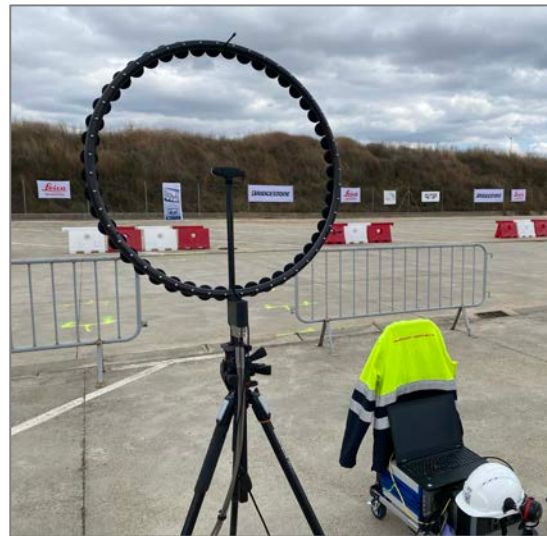
Figura 1 – Array de 48 micrófonos electret y geometría circular utilizado, de gfai tech GmbH .
