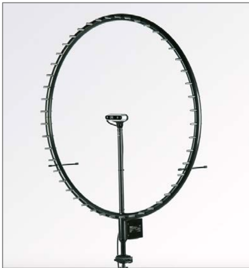
Figura 1 – Array de 48 micrófonos electret y geometría circular utilizado, de gfai tech GmbH .
