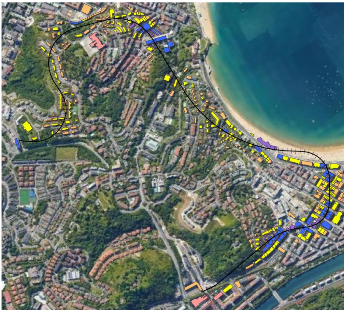
Figura 5 – Niveles de ruido obtenidos en los edificios más cercanos a la traza.
