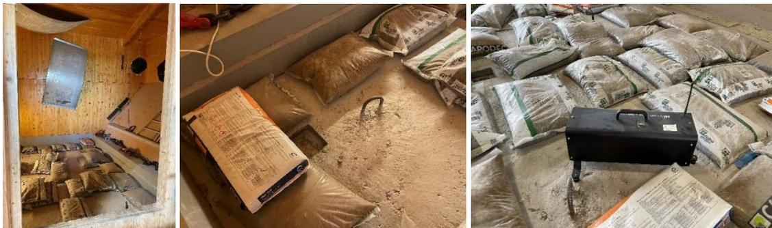
Figura 3 – Sobrecarga de uso de 100 kg/m<sup>2</sup>, simulada mediante sacos de arena.
