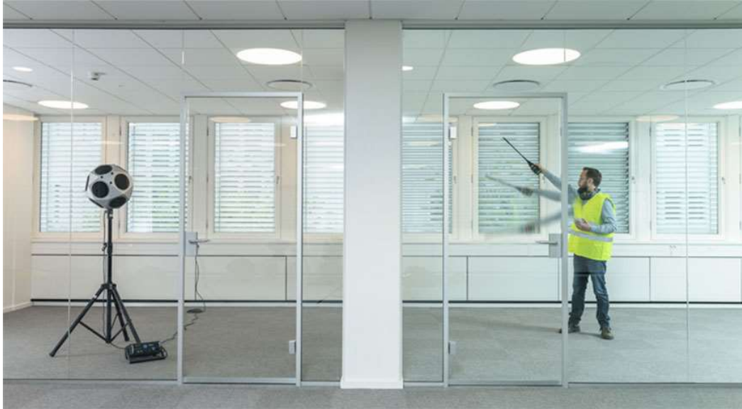
Figura 1 – configuración típica en medidas de aislamiento acústico mediante barrido manual
