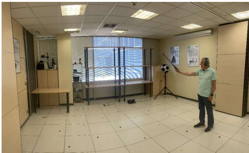
Figura 5 – Imagen de la sala y operador realizando medida mediante el método manual
