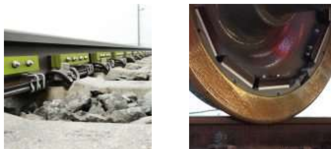
Figura 3 – Ejemplos de absorbentes de sonido VICON AMSA para carril y VICON RASA para ruedas, de la empresa Schrey und Veit [4].
