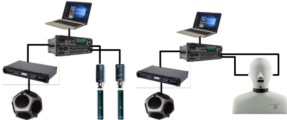
Figura 3 – Diagrama de montaje: con micrófonos omnidireccional y bidireccional; con HATS
