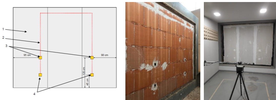
Figura 13. Esquema de colocación de las instalaciones: 1. Placa de yeso laminado 12,5 mm, 2. Tubo corrugado, 3. Interruptores, 4. Enchufes. Fotografías de la muestra ensayada.
