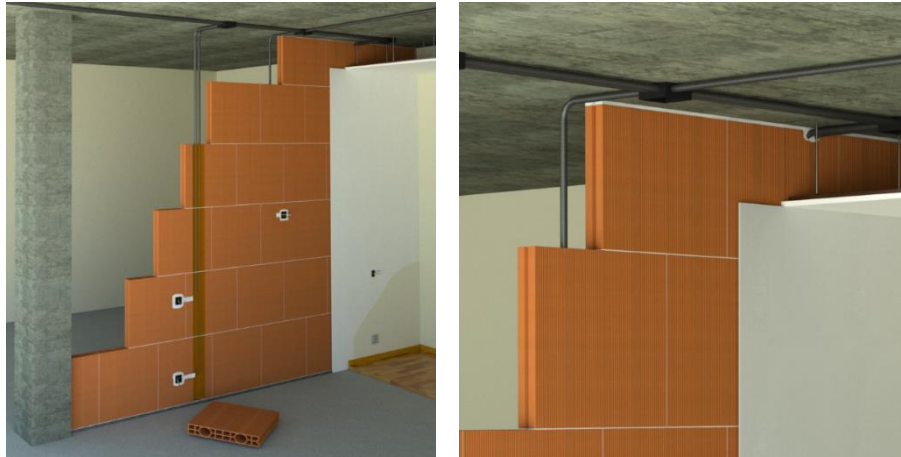
Figura 9 - Detalles de la colocación de las instalaciones en una fábrica de MURALIT Sin Rozas en una obra CON FALSO TECHO
