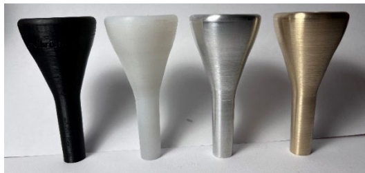
Figura 2 – Resultado final de la fabricación de las 4 boquillas.
