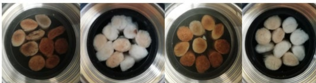
Figura 5- Influencia de la limpieza química en la apariencia de las muestras.
