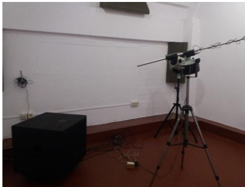
Figura 2. Fotos de las salas receptora y emisora de las cámaras de transmisión horizontal
