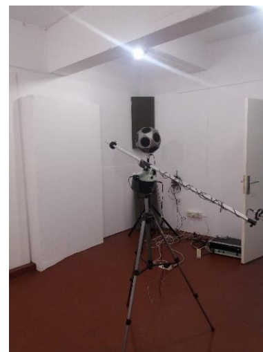
Figura 2. Fotos de las salas receptora y emisora de las cámaras de transmisión horizontal
