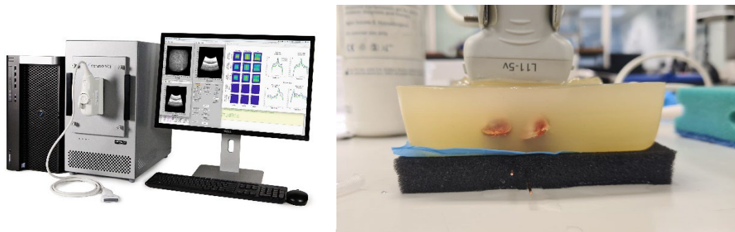
Figura 1. Sistema 256-vantage Verasonics y phantom de pulmón donde se aprecian las costillas de cerdo dentro de la gelatina, la esponja que simula el tejido pulmonar con las dos inclusiones metálicas y la pleura simulada por una capa de nitrilo.
