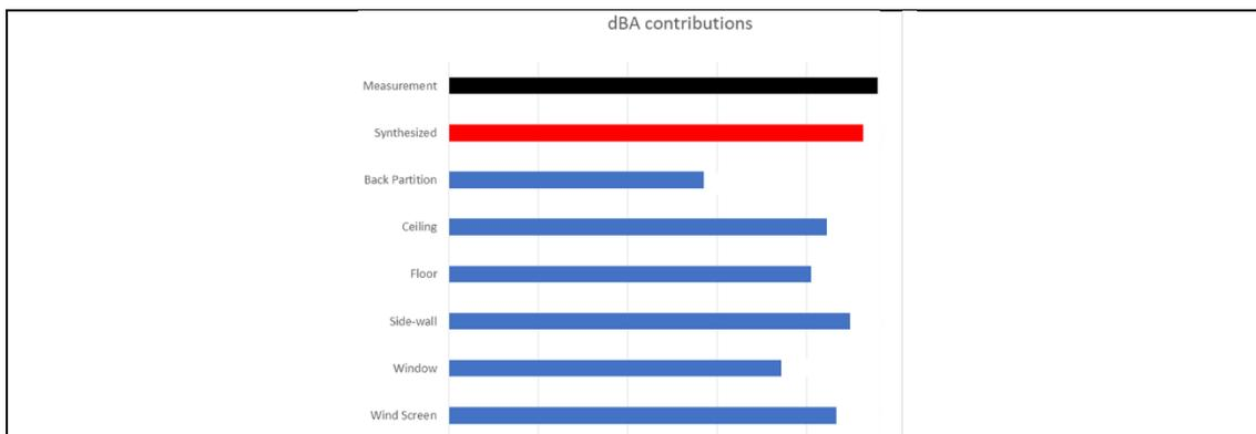
**Figura 6.** Contribuciones de los paneles interiores en dBA para la condición VTOL 100%.5
