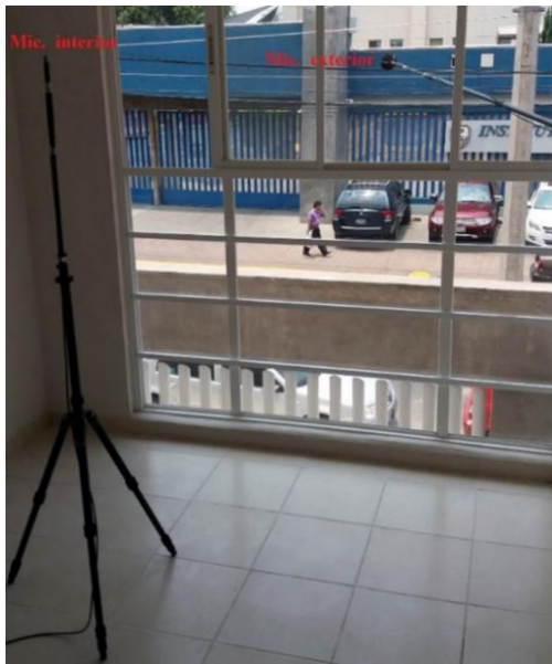
Figura 12 - Posición de micrófonos para la medición de la diferencia de nivel estandarizada ( D_{tr,2m,nT} ), de la fachada.
