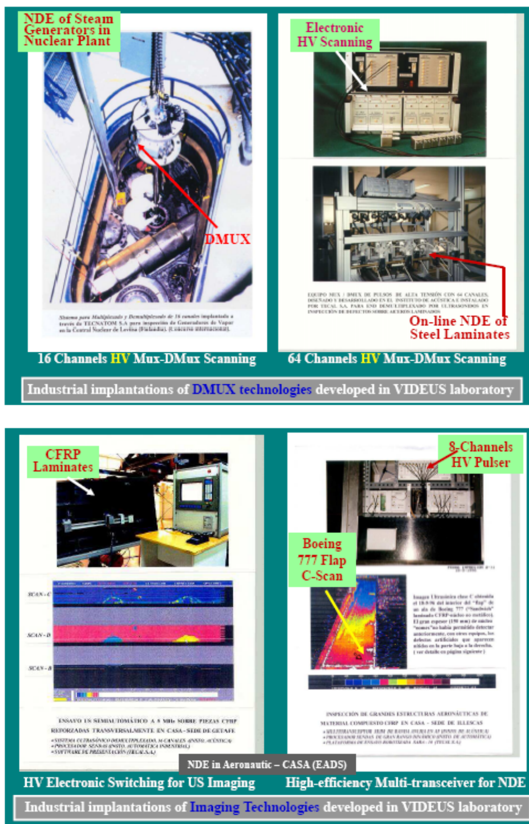
Fig. 1. Tres ejemplos de aplicación de la investigación en grupo Videus, para desarrollo de tecnologías multicanal de inspección por imagen ultrasónica en los sectores: nuclear, siderúrgico y aeronáutico.
