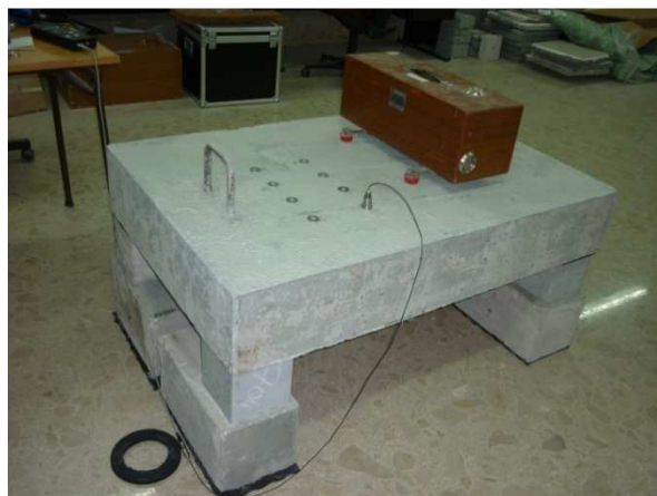
Figura 1 - Fotografia do sistema de ensaio implementado para obter a redução sonora conferida por revestimentos de piso.
