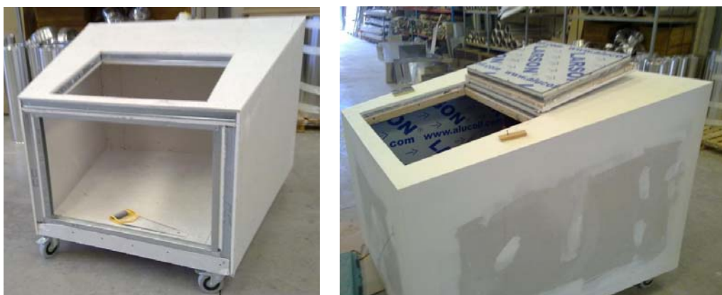
Figura 7. Detalle cámara reverberante a escala a falta del cierre lateral.
