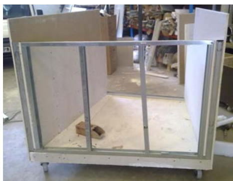
Figura 3. Construcción de la cámara reverberante a escala. Montaje de suelo y paredes.
