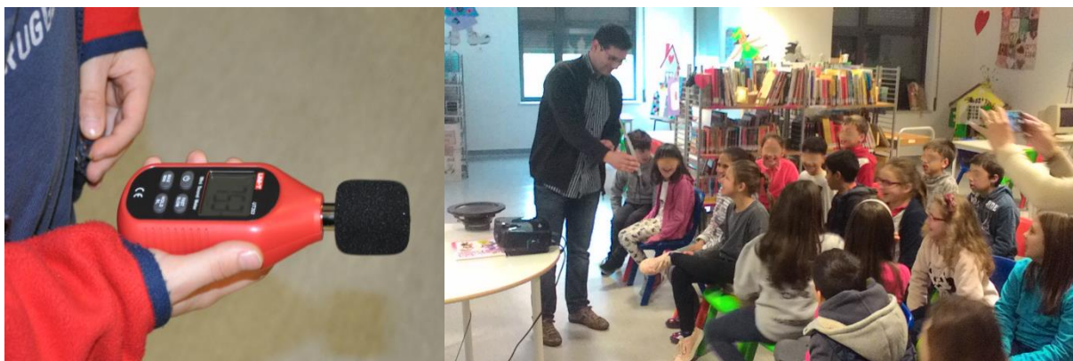
Figura 4 – Medição de NPS em várias situações: todos em silêncio; a movimentar os membros; a falar; a gritar.
