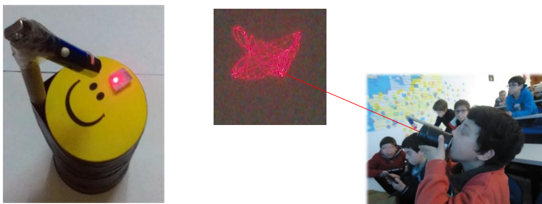
Figura 3 – Protótipo de sistema para visualizar a vibração produzida pela voz (esquerda); exemplo da utilização do protótipo construído e figura produzida (direita).
