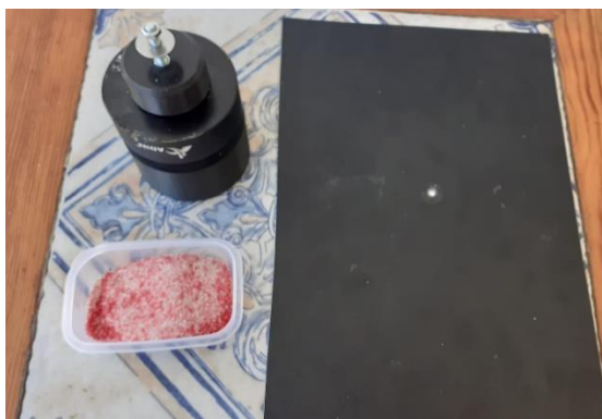
Figura 12 – Protótipo de gerador das figuras de Chladni.
