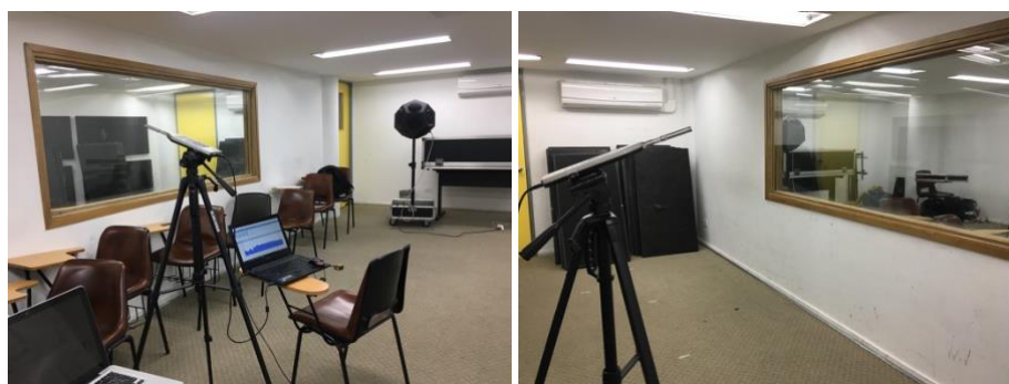
Figura 4 – Vista del elemento separador desde el recinto emisor (izquierda) y el receptor (derecha).
