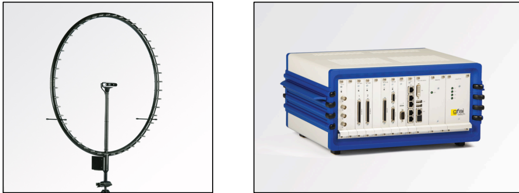
Figura 1 – Array de micrófonos RING 48 AC PRO y sistema de adquisición mcdRec de gfai tech .
