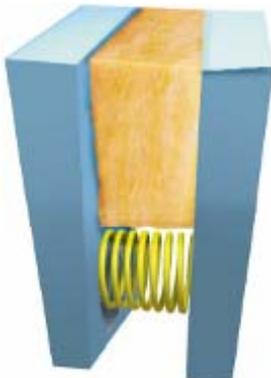
Los sistemas con lanas minerales funcionan bajo el principio de “Masa – Muelle – Masa”; la eficacia de estos sistemas se fundamenta en la ELASTICIDAD de la lana, ya que esta funciona como un muelle amortiguando la vibración del aire que forma el sonido.
