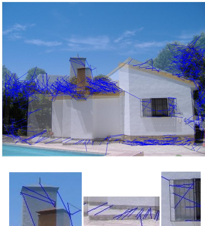
Figura 4. Resultados del emparejamiento por correlación. En las subimágenes inferiores, detalles de la imagen superior.
